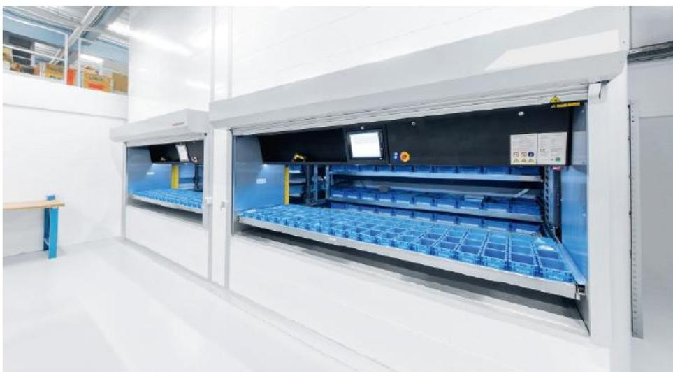
Рабочие отверстия модулей вертикального подъемника расположены на «основном этаже» склада, в то время как модули расположены от подвала и вплоть до потолка основного помещения.
