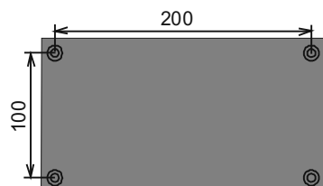
Рисунок 4 – Размеры для выбора настенного кронштейна
