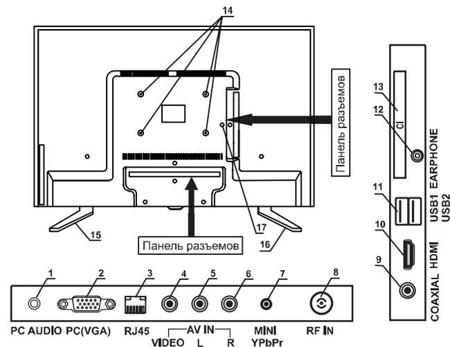
1 — разъем PC AUDIO для подключения звукового сигнала с компьютера; 2 — разъем PC(VGA) для подключения видеосигнала с компьютера; 3 — вход RJ45 для подключения к сети Интернет;
