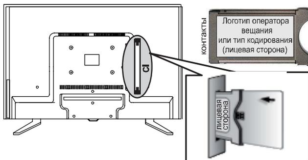
Рисунок 5 – Установка CA-модуля
