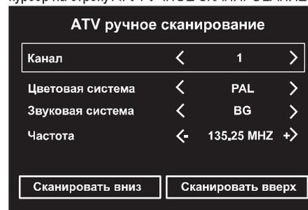
В строке КАНАЛ кнопками ◀/▶ выберите номер канала, частота которого наиболее близка к частоте искомого канала (см. строку ЧАСТОТА). Затем установите курсор на нужную Вам вкладку: СКАНИРОВАТЬ ВНИЗ или СКАНИРОВАТЬ ВВЕРХ. Нажмите кнопку ОК.
