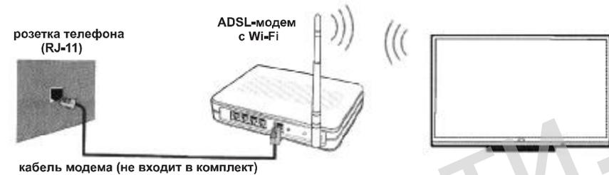
Рисунок 6 – Беспроводное подключение
